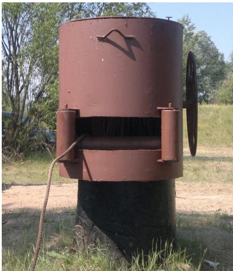
Рисунок 3.2 – Свайный якорь с установленной лебедкой
